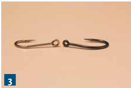
3 Nicht jeder Einzelhaken eignet sich für die Nachrüstung. Der Vergleich macht es deutlich; links ein geeigneter Haken mit relativ großem Öhr, rechts ein Streamerhaken vergleichbarer Größe mit viel kleinerem Öhr. Daran ist kein Sprengring zu befestigen.
