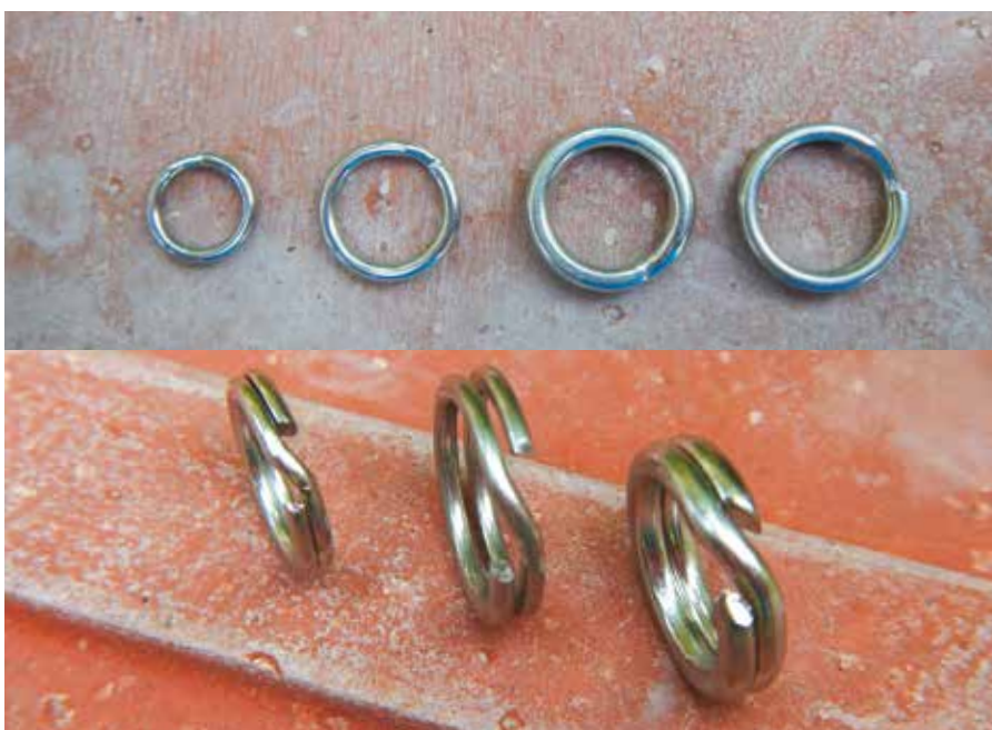
Sprengringe unterschiedlicher Größe und Stärke: Bei der Auswahl starker Modelle ist zu beachten, dass es nicht nur um die Größe der Ringe geht, sondern dass die Stahldicke entscheidend ist.
