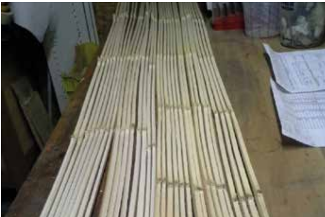
Zunächst werden aus dem Bambusrohr (Tonkinrohr) die einzelnen Spliße heraus gespalten
