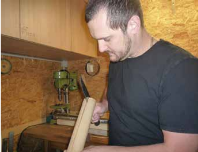
Zunächst werden aus dem Bambusrohr (Tonkinrohr) die einzelnen Spliße heraus gespalten
